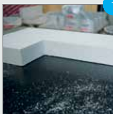
Manuele of machinale versnijding van isolatie-paneel in "L"-vorm.
